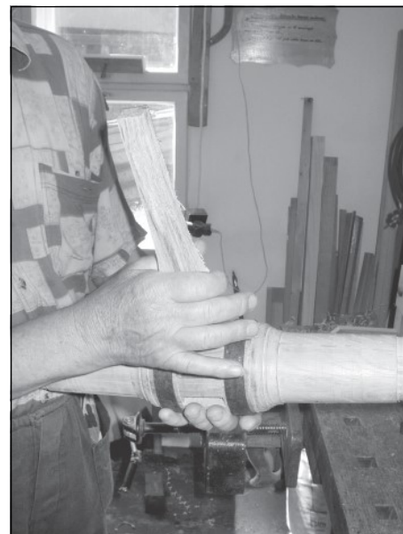
Zasazení paprsků („špic“) do náboje – přesně vymeřený sklon a délka špice
